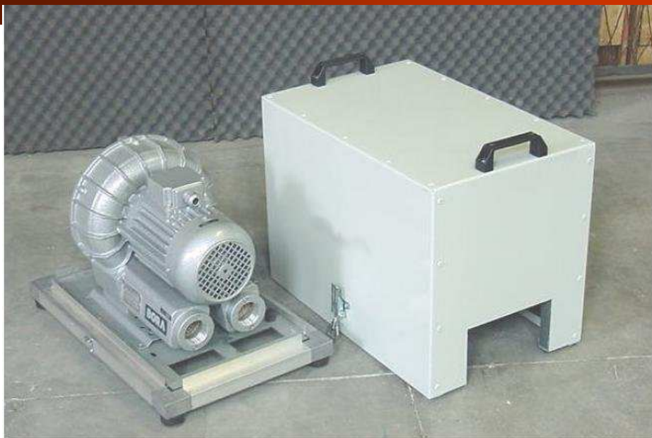
Soffiante con sistema di insonorizzazione
